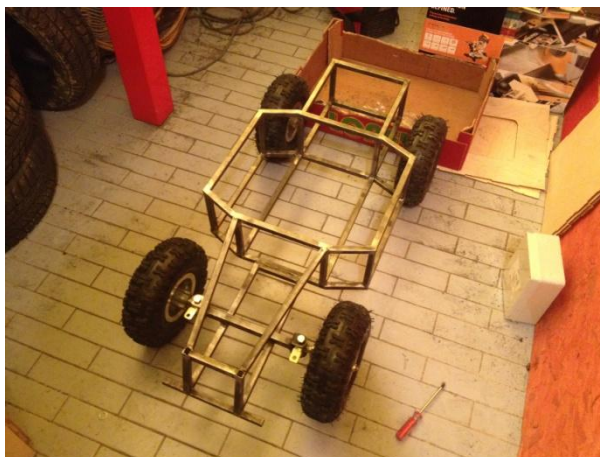
Obr. 17 Hlavní nosná část
