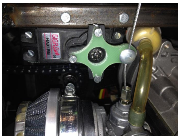
Obr. 24 Servoregulace množství nasávané směsi
